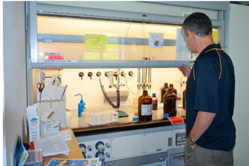
Arbeiten am Säureabzug: Hier werden die Lipide der Fische extrahiert. Spezielle Lösungsmittel helfen bei der Auftrennung von Lipiden und deren Fettsäuren.
